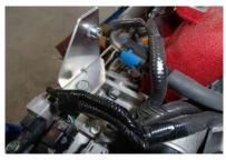
インジェクタードライバーステーを画像の位置に元のボルトで仮り付けします。
