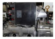
インジェクタードライバーを元の付いていたボルト 2本で仮り付けします。
