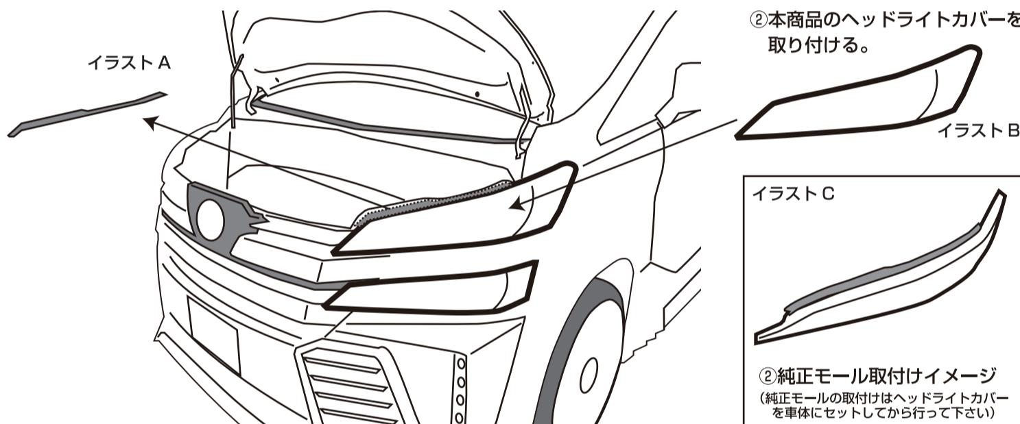
③最初に取り外した純正モールを本商品のヘッドライトカバー上部へ取り付ける。
