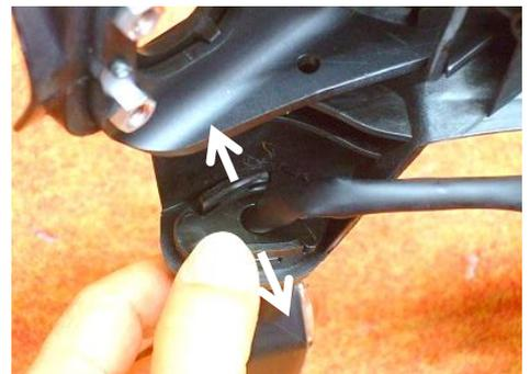
ナンバー灯は付属のカップラーに端子を挿入してから結線します。
