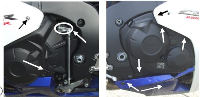
注) 右側上部は、カウル内に隠れています。カウルステーは、フレームへの取付ボルトを緩めておいたほうが、フレームカバーを装着し易いです。
