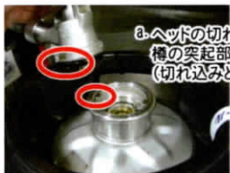
b.止まるまで右に回してヘッドを樽に固定します。(約90度回ります。)
