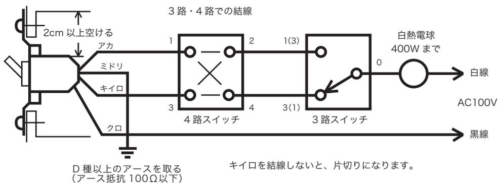
※使用できるランプは白熱球のみです ハロゲンランプ・蛍光灯（電球型を含む）・LEDランプ、水銀灯・トランスを使用した白熱電球器具などには使用できません。
