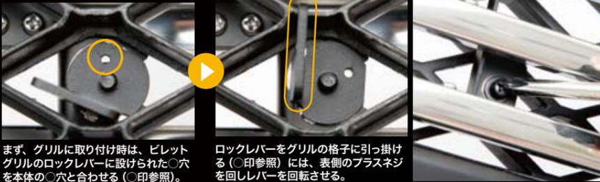
まず、グリルに取り付け時は、ビレットグリルのロックレバーに設けられた○穴を本体の○穴と合わせる(○印参照)。
