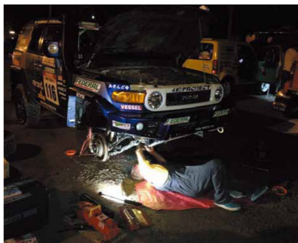
ステアリング・リンケージとアルミブロックの干渉箇所からオイルが漏れ、パテで応急処置を施す。しかし、ラリーには耐えられないと、最終日はエスケープを選択した。
