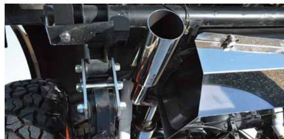
下廻りの露出が増えた部分は、ステンレス製タンクガードとスポーツマフラーを装着してスタイリッシュ感を演出。
