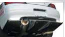
□ REAR UNDER PANEL (材質:カーボン&FRPコンビネーション) ※縫織り仕上げ
