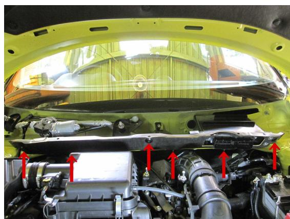
樹脂ネジを手で回してカウルフロントサイレンサを取り外してください。
