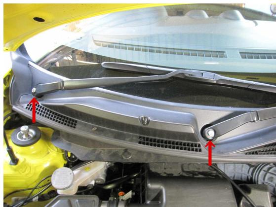
矢印部分のキャップとその下のナットを外してワイパーームを取り外してください。
