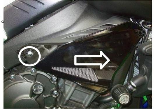
2) 写真② □印部ボルトを外し、カバーベースを取り外します。
