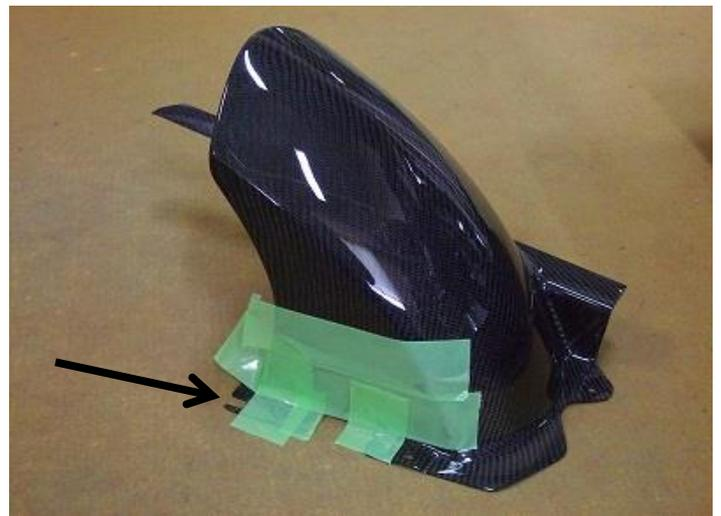
(注意) リアをローダウンしている車両は、Rr.ブレーキリザーブタンクが、リアフェンダーと接触する可能性がありますので、リザーブタンクを 5mm 程度オフセットしてください。
