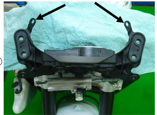
2) フレームの両サイド矢印部(写真②)の、ゴムグロメットを取り外し、付属の M6 ウエルナットを挿入します。
