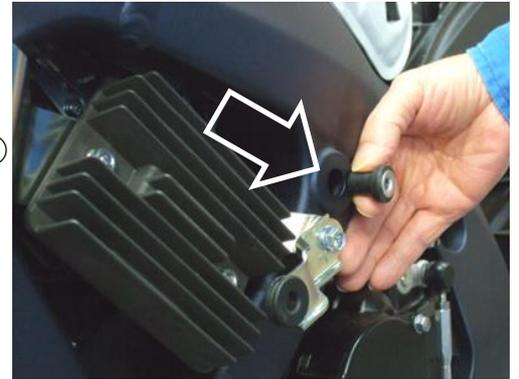
3) エアードクトをカウルにはめ込み、後部をノーマルプラリベットで、カウルに固定します。(写真③ 矢印部)
