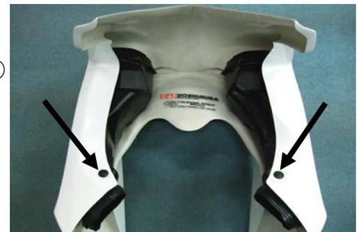
5) アンダーカウルを付属のクイックファスナーにてアッパーカウルに取り付け、右後部は写真④矢印部に、付属のボタンボルト(M5×15)とステンワッシャ、ゴムワッシャにて取付けます。
