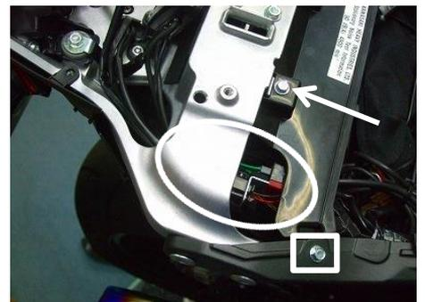
9) フェンダーレスキットをシートレール裏からあてがって、付属のボタンボルト、ステンワッシャー、Uナットにて仮固定します。
