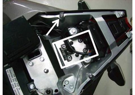
4) 写真 ④ 矢印部のボルト左右と、口部ボルトを外し、黒いプラプレートをシートレール下からひねり抜きます。
