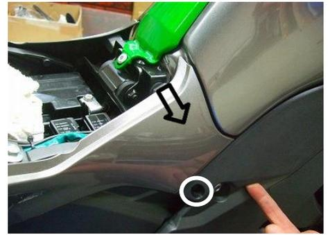
(注意) 写真の指先付近の突起が車体側ゴムグロメットに差し込んであり、さらに15cmほど前の爪がフレームに引っ掛かっていますので、破損しない様に注意してください。
