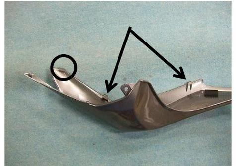
7) 取り外したフェンダーの 写真 ⑤ 丸印部ビス 2本を外し、フェンダーを分解します。
