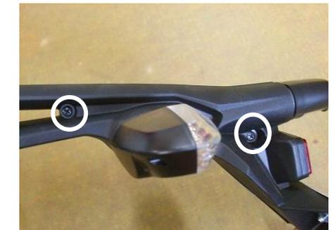
11) 付属のリフレクターステーとナンバープレートを、フェンダーレスに共締めし、リフレクターは、ノーマルから移植します。
