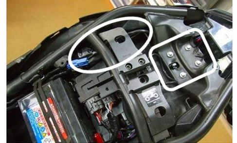
5) 写真④外したフェンダーの表から見えるボルトを全て外し、フェンダーを解体します。
