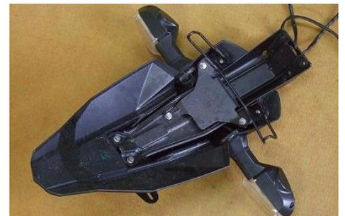
8) フェンダーレスキットをアンダーパネル裏からあてがって、ガムテープ等で仮固定し、先にハーネスを元の状態に処理します。
