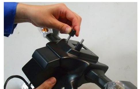
12) シートカウルを元通り装着し、フェンダーレスのひねり等を調整した後、10)のボルト類を本締めします。
