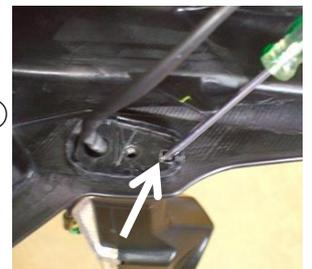
10) 付属のボルト(M6X20)、ステンワッシャーを前側2箇所の穴に通し、アンダーパネルを持ち上げ、4本のボルトをシートレールステー穴に通し、付属のステンワッシャー、Uナットにて仮締めします。
