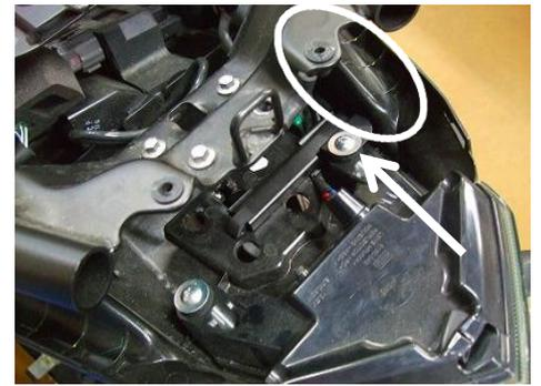
ウインカーをつかんで、ひねりながら抜き取り、フェンダーレスに、ノーマル同様に固定し、付属のLEDナンバー灯をフェンダーレスキットに装着します。
