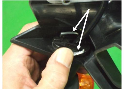
3) FRPフェンダーレスに付属のLEDナンバー灯を取り付け、ウインカー、ナンバー灯のハーネスを束ね、付属のコルゲートチューブの中に通します。
