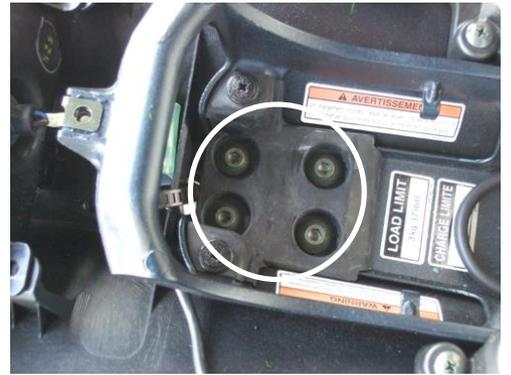
2) ウインカー裏のゴム(写真② 矢印)を指先でめくり、プラベースを外し、フェンダーからウインカーを取り外し、フェンダーレスキットに逆の手順で組み付けます。
