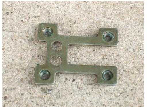
6) フェンダーレスを、付属の皿ビス、黒ワッシャー、キャップナットにてステー下に取り付け、ハーネスをフェンダーレス、ステーのそれぞれの中央穴をストレートに貫通させ、シートカウル内に入れ込みます。
