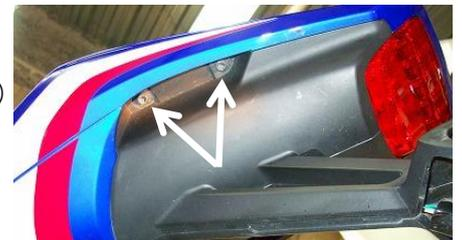
注) トレー先端は、写真⑥○囲み部の爪と連結されていますので、破損しない様に注意してください。
