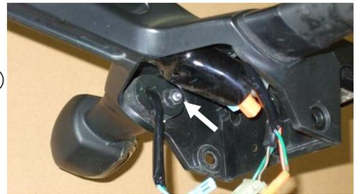
3) ナンバー灯カバー天井部ビス2本を外し、ナンバー灯を取り外します。
