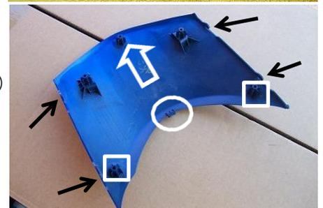
10) シートロックのプレートを入れ込み、後方は外した純正ボルト、前方2箇所は、付属のフランジボルト(M6X10)で固定します。
