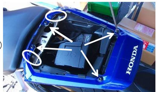
注) 写真⑤矢印部、4箇所(爪)が、写真⑥アンダーパネルの爪(矢印部)に引っかかっていますので、折らない様に慎重に作業してください。
