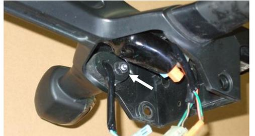
3) ナンバー灯カバーの天井部ビス2本を外し、ナンバー灯を、カバーごと取り外します。
