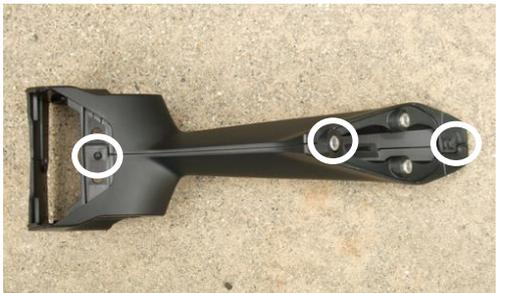
9) 5)で組み付けたフェンダーレスキットを下からあてがって、6)で外したノーマルボルトにて固定します。
