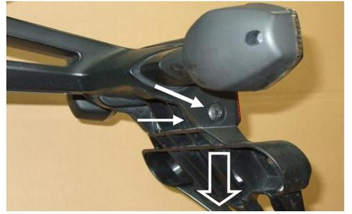
2) ウィンカー、ナンバー灯のカップラーを外します。
