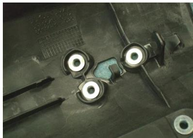
8) 写真⑤の様に、太めのドライバー等を突っ込み、カラーを外し、写真⑥の様に、上からはめます。
