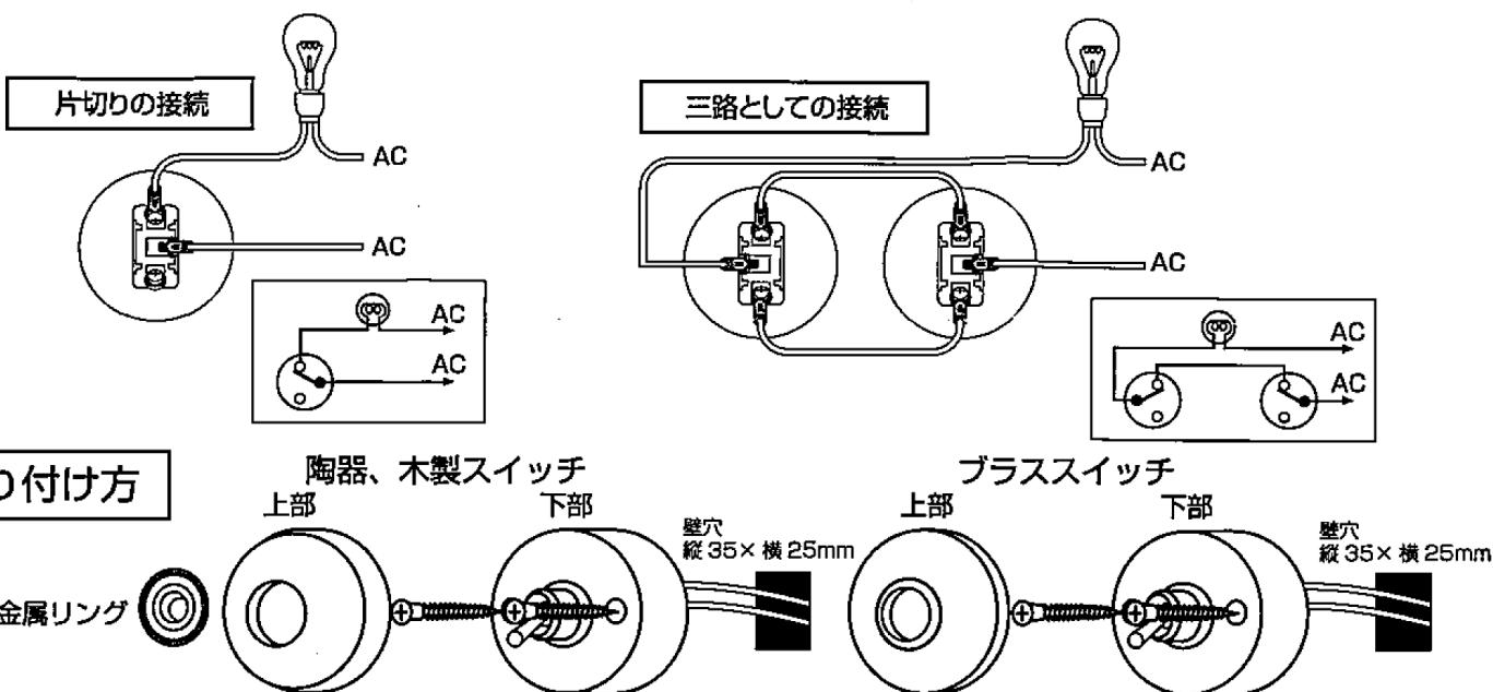
1. スイッチ中央の金属リングを回し、スイッチ上部を外して下さい。プラススイッチの場合は、上部の穴がネジになっています。
