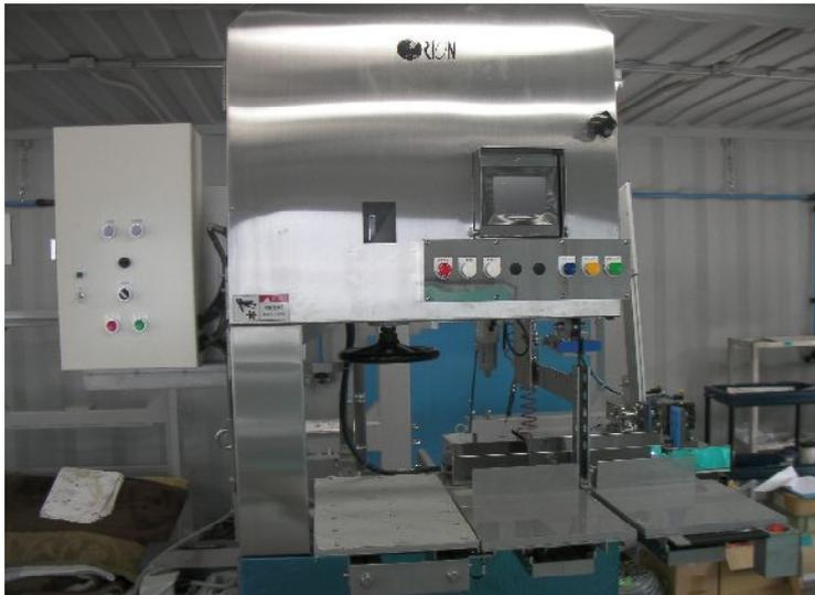
霧丸ⅢJBR 仕様：バンドソーモーター電源：三相200V2.2KW ホイール直径650バンドソー4450L
