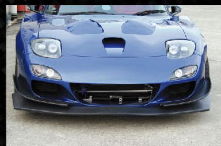
エンジンルーム下側をフラットボトム化し、エアーの流速を高めその圧力差によるベンチュリー効果でフロントが路面に吸い付き、空気抵抗をほぼゼロのダウンホースが得られます。フロントの接地感、コーナー侵入時の回頭性が向上。
