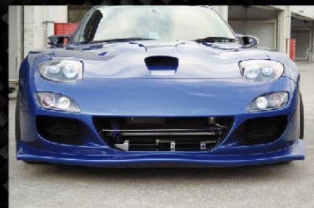
フロントバンパーはノーマルフェンダーにも対応致しております。オイルクーラーの左右のダクトはオイルクーラーのコア付近まで伸びており、確実にエアをオイルクーラーに伝えます。これにより油温の上昇を防ぎます。中央部のダクトも内部まで伸びており水温の上昇を防ぎます。別売でカーボンディフューザー、カーボンカナードが装着可能です。
